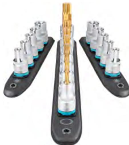
Die magnetische Unterseite gewährleistet perfekten Halt z.B. an Werkstattwagen, Maschinen etc. Die Rails verfügen über langlebige, robuste Drehverriegelungen, die die Steckschlüssel sicher im arretierten Zustand fixieren sowie einer robuste Metallöse zum Aufhängen. Piktogramme signalisieren dem Anwender sofort das gewünschte Schraubprofil und aufgedruckte Schlüsselweiten die gewünschte Größe.
